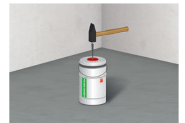
4 Durchstoßen des Deckels mit eingefüllter Härterkomponente
