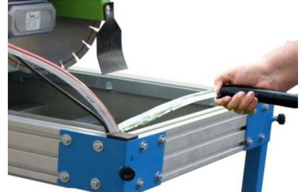
Halten Sie den Wasserkreislauf möglichst frei von Materialresten und Ablagerungen. Wir empfehlen Ihnen das Wasser immer wenn notwendig zu wechseln um die Kühlung der Schneidescheibe und die korrekte Rotation der Wasserpumpe zu garantieren. Die Wasserwanne enthält einen Stöpsel um das Reinigen der Maschine zu vereinfachen.
