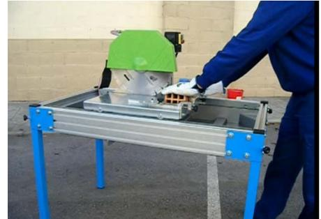
Nach dem Anschliessen des Netzkabels, wird der Motor und die Pumpe durch das Betätigen des grünen Schalters gestartet.
