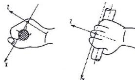
\*\*Vibración medida en la empuñadura de la máquina (como muestran las imágenes)
