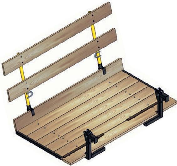
➔ Die Betonierbühne ORMA 2,4 x 1,2 m entspricht der DIN EN 12811 Teil 1 3/2004, Lastklasse 2 und ist für eine Belastung von 1,50 kN/m<sup>2</sup> ausgelegt.
