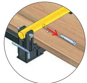
2. Rückenschutzgeländer soweit hochklappen, bis der erste Bolzen unten aufschlägt. Anschließend den Bolzen A mit Federstecker wieder einbauen:
