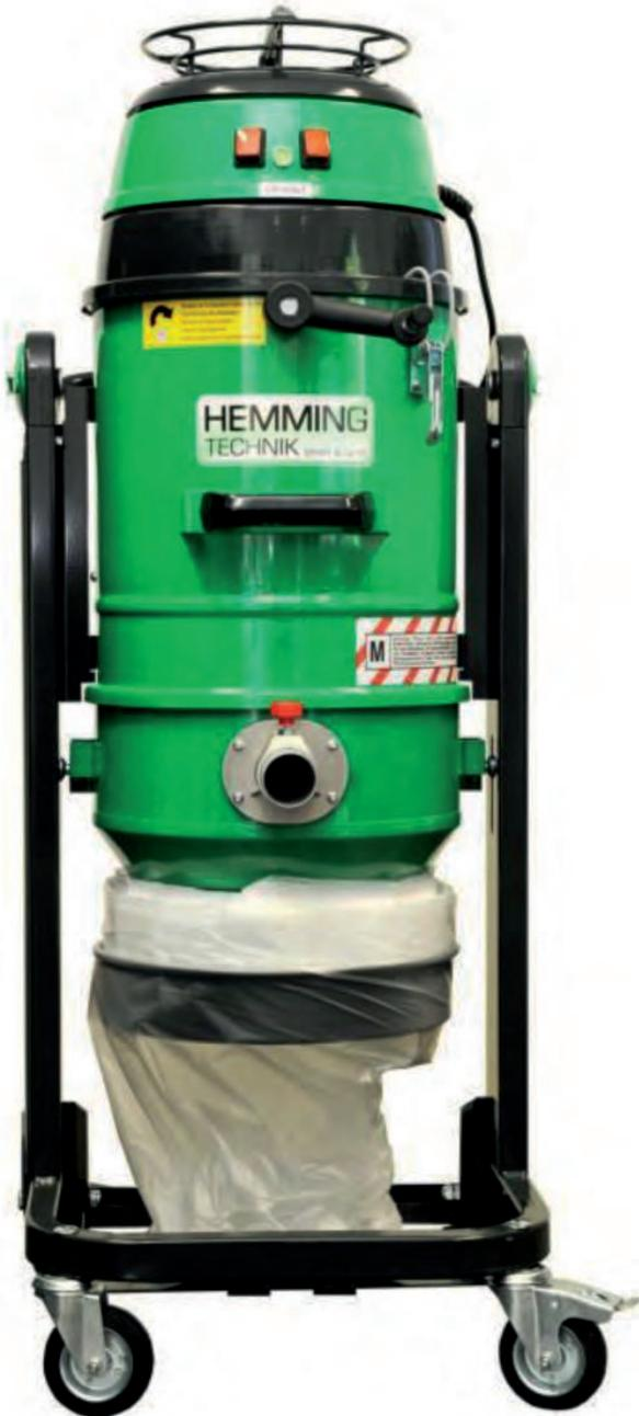
Der Sauger wurde speziell für die Aufnahme von großen Mengen Feinstaub in kürzester Zeit entwickelt und verfügt über zwei einzeln zuschaltbare 1150-Watt Bypass-Saugmotoren in einem robusten Metallgehäuse. Ein Unterdruckanzeiger erlaubt die kontinuierliche Kontrolle des einwandfreien Betriebs und der möglichen Filterbelastung. Ein Warnlicht zeigt eventuelle Filterprobleme.
