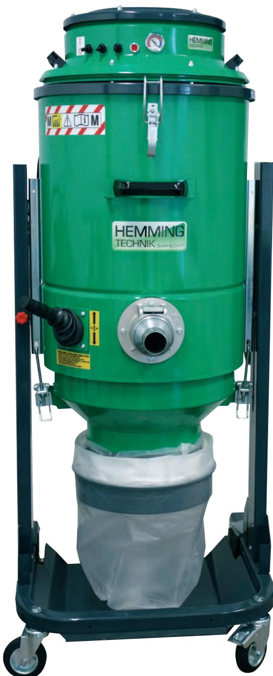
Der Sauger wurde speziell für die Aufnahme von großen Mengen Feinstaub in kürzester Zeit entwickelt und verfügt über drei einzeln zuschaltbare 1150-Watt Bypass-Saugmotoren in einem robusten Metallgehäuse. Ein Unterdruckanzeiger erlaubt die kontinuierliche Kontrolle des einwandfreien Betriebs und der möglichen Filterbelegung. Ein Warnlicht zeigt eventuelle Filterprobleme.
