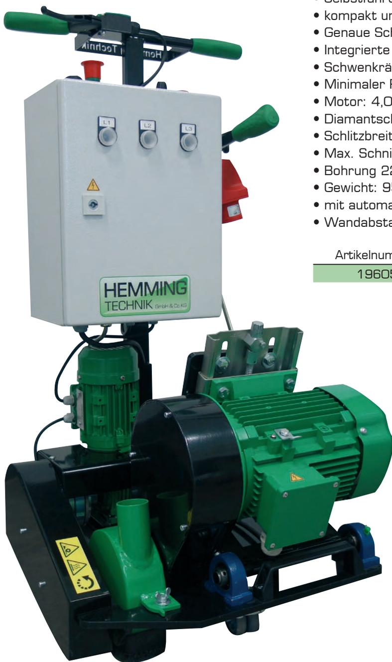
Die Kompaktsteuerung regelt die Drehrichtung, Stromzufuhr und Vorschubgeschwindigkeit.
