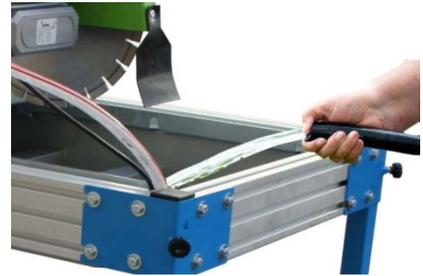
Während der Schneidevorgänge sammelt sich viel Schmutz in der Wasserwanne, so dass Sie so oft wie möglich, um den reibungslosen Betrieb der Pumpe und die perfekte Kühlung der Trennscheibe zu gewährleisten, das Wasser wechseln müssen. Die Wasserwanne verfügt über einen Ablassstopfen, welcher diesen Vorgang sehr erleichtert.
