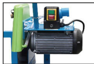
Motor de 2.2 Kw.
