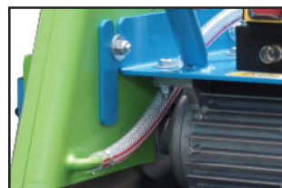
Sistema de circulación de agua para corte húmedo.
