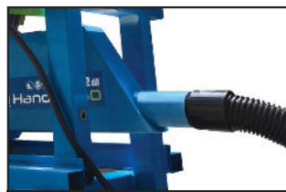
Conexión con aspirador.
